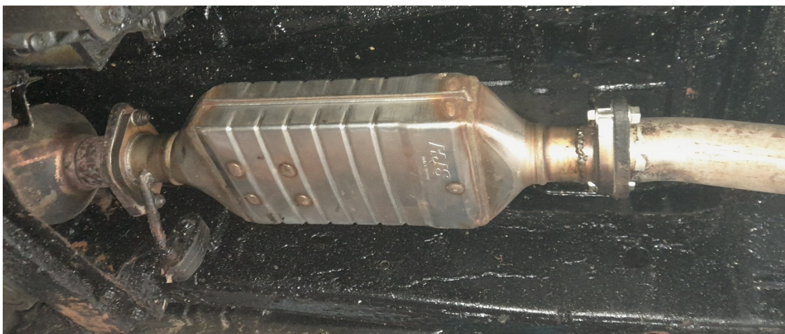
DPF monteret efter katalysator, før lydpotte (Foto: Bilmageriet)
